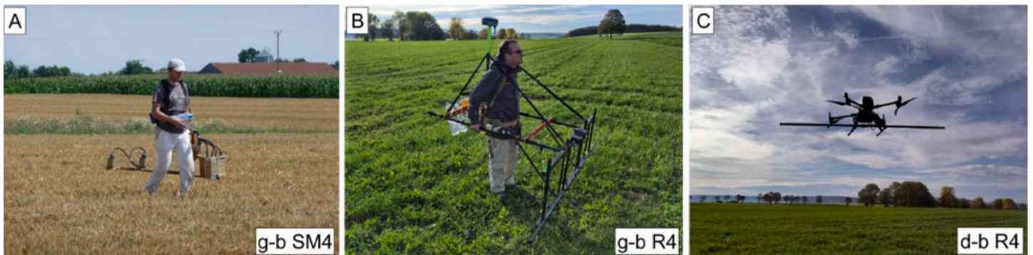
图片说明：A) 地面网格模式下的 Smartmag SM4G 磁力仪。B) 地面 GNSS 模式下的 Sensys R4。 C) 无人机 GNSS 模式下的 Sensys R4。
