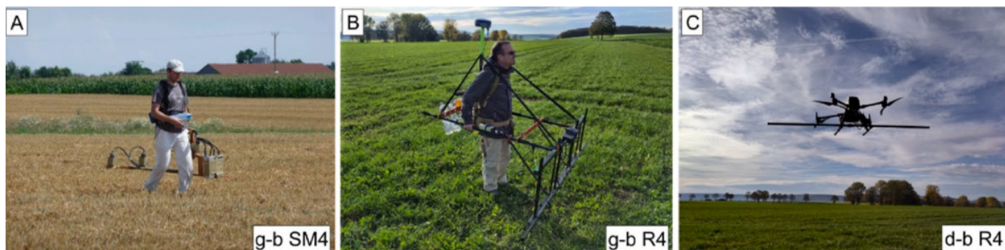
Ilustración: A) Magnetómetro Smartmag SM4G en modo de cuadrícula terrestre. B) Sensys R4 en modo GNSS terrestre. C) Sensys R4 en modo GNSS en dron.
