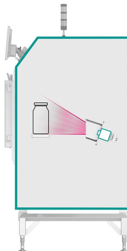
Strahlengang parallel zum Boden
