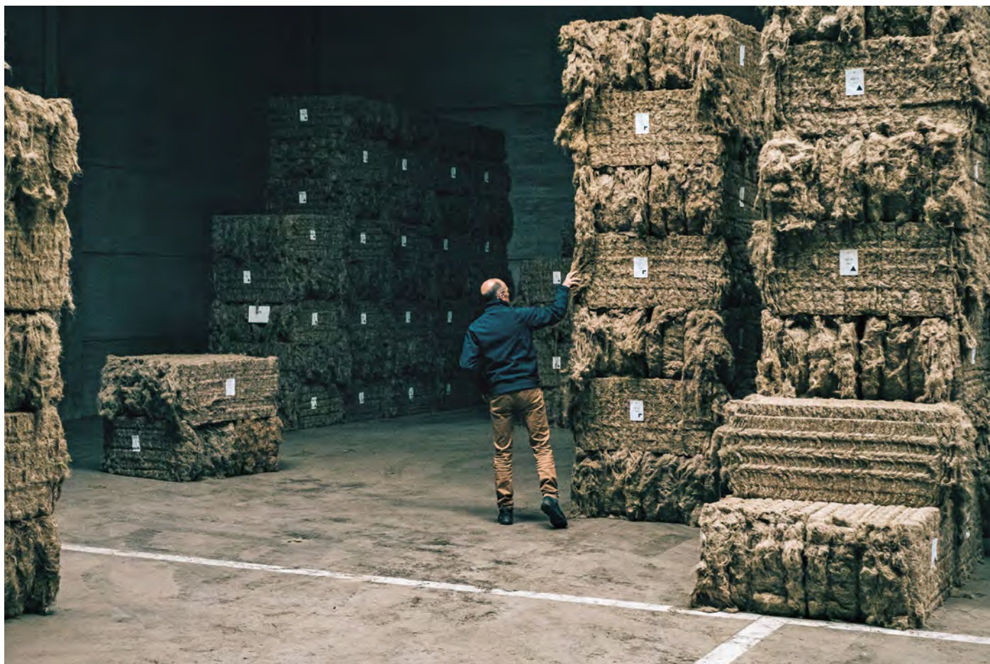
Depuis 1949, le teillage Decock à Hondschoote, dans le Nord, transforme 26 000 tonnes de paille de lin par an, pour aboutir à 7 500 tonnes de fibres teillées. Le teillage est le battage mécanique des tiges de la plante qui permet de séparer la fibre de la paille. Une étape ancestrale qui n'a que peu changé depuis les débuts de la mécanisation.
