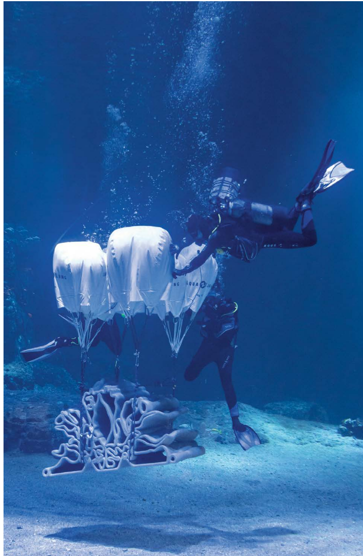
Immersion d'un module en mortier bas carbone dans l'aquarium du centre Nausicaá, afin d'observer la colonisation des récifs par la faune et la flore.
