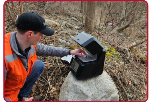
Um XRF portátil inovador que opera com **SEGURANÇA** a 80kV proporcionando limites de detecção de um dígito de ppm para ETRs leves e pesados.
