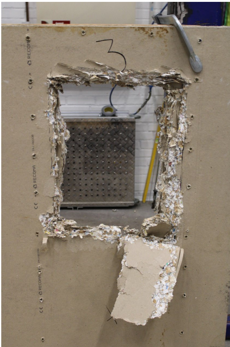
Figur 9 - Forcerad vägg efter angrepp, Test 3 (3 skivor)
