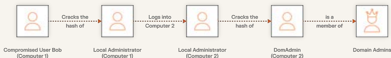
Figure 3. Les cybercriminels progressent d'un seul utilisateur compromis à un accès administrateur de domaine en réutilisant des hachages et des identifiants volés. Ils peuvent ainsi se déplacer latéralement sans devoir craquer de mots de passe.
