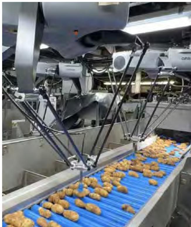
*Le trieur robotisé SiftAI® peut accueillir jusqu'à deux robots de tri travaillant ensemble.*
