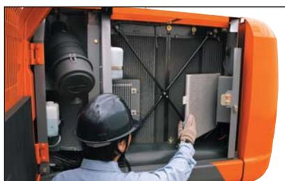
Anstatt wie bei der herkömmlichen Reihenanordnung sind Ölkühler, Wasserkühler und Ladeluftkühler parallel angeordnet. Diese Parallelanordnung lässt sich wesentlich einfacher um den Motor herum reinigen. Der Klimaanlagekondensator lässt sich klappen, so dass die Reinigung des Kondensators und des dahinter befindlichen Wasserkühlers vereinfacht wird.
