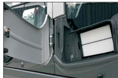
Breite Türen bieten von der Bodenebene aus Zugang zum Kraftstofffilter, Wasserabscheider und Motorölfilter. Ein großer Handlauf, Stufen und Antirutschplatten führen zur Motorabdeckung. Die Motorölwanne ist mit einer Ablasskupplung ausgestattet. Beim Ablassen wird ein entsprechender Ablassschlauch mit der Kupplung verbunden. Die Ablasskupplung ist zuverlässig, wodurch Öllecks und Vandalismus vermieden werden.
