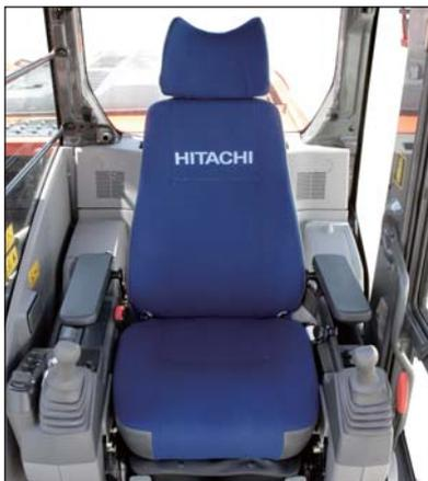
Breite, verstellbare Armlehnen und ein 2-Punkt-Automatik-Sicherheitsgurt sind Teil der Serienausstattung. Kurze Steuerhebelwege ermöglichen langen Betrieb mit weniger Ermüdungserscheinungen. Drei Schalter am Hebel (optional) können für den Betrieb von Sondergeräten vorgesehen werden. Die Überdruckkabine verhindert wirkungsvoll das Eindringen von Staub. Durch elastische und mit Silikonöl gefüllte Viskosedämpfer, auf denen die Kabine ruht, werden Geräusche und Vibrationen minimiert.
