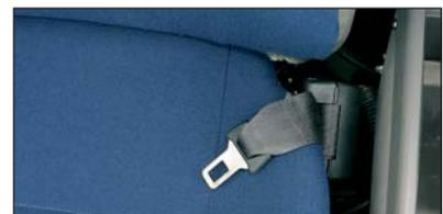
Weitere Merkmale sind ein Automatik-Sicherheitsgurt, ein Nothammer und eine Motornotabschaltung. Ein Absperrhebel für die Vorsteuerung trägt dazu bei, unbeabsichtigte Bewegungen zu verhindern. Des Weiteren ist eine FOPS-Schutzvorrichtung (Falling Object Protective Structure) als Sonderausstattung erhältlich. Für die Kabinenfenster kann Verbundglas oder getempertes Glas gewählt werden.
