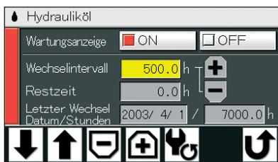
Beim Einschalten der Zündung werden nach Erreichen der vorprogrammierten Wechselintervalle für Hydrauliköl- und Kraftstofffilter die entsprechenden Wartungshinweise in das Display eingeblendet. Die planmäßige Wartung kann den Ausfall der Maschine verhindern.
