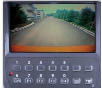
Der breite LCD-Farbmonitor in Verbindung mit der auf dem Gegengewicht montierten Heckkamera bietet dem Fahrer auch eine Rückwärtssicht vom Heckbereich der Maschine.
