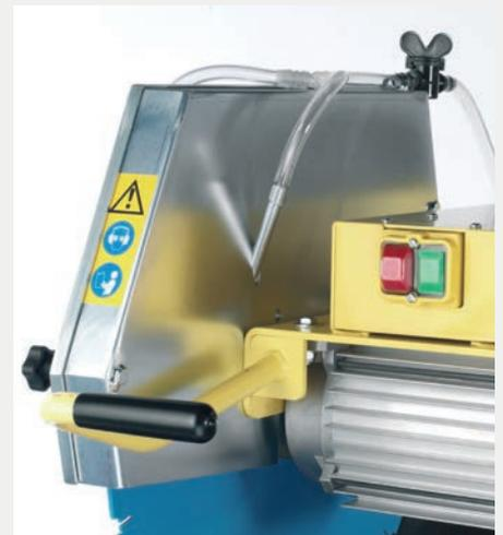
Integrierter versenkter Schalter und mehrfach gelagerter Wippkopf sichern Langlebigkeit und hohe Funktionalität.
