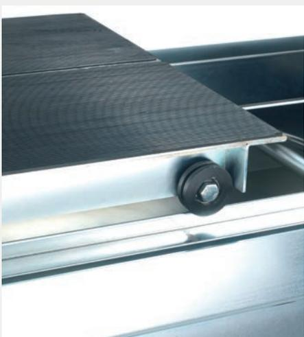
Der auf Präzisionsmetallrollen und Kugellagern geführte Schneidetisch sichert hohe Stabilität, Schnittgenauigkeit und Langlebigkeit.
