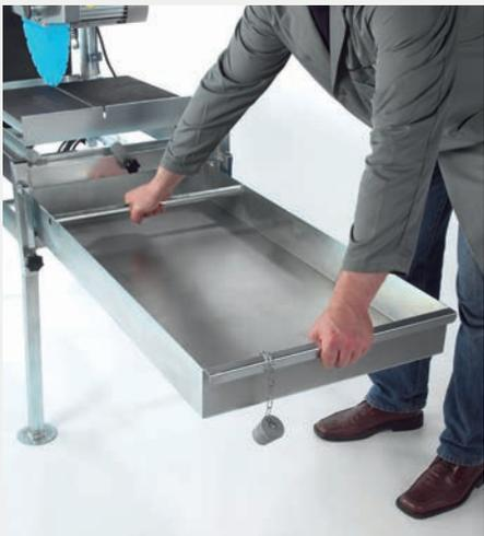
Nach vorne ausziehbare Wasserwanne. Praktisch für die rasche und einfache Reinigung.
