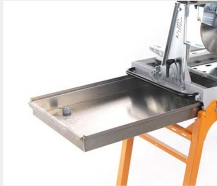
Ausziehbare, leichte Wasserwanne aus Aluminium zur einfachen und schnellen Reinigung.
