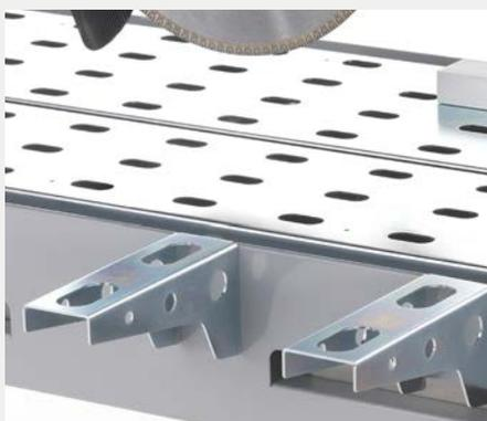
Die beidseitige Tischverbreiterung ermöglicht ein solides Auflegen von Grossformatplatten.
