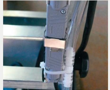
Wasserpumpe mit Steckverbindung zur raschen und sicheren Wartung.
