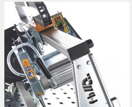
Führungsbalken aus INOX-Stahl für dauerhafte und höchste Präzision beim Schneiden.
