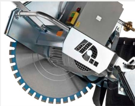
Elektronische Motorbremse und Sanftanlaufregler für höchste Sicherheit und schnellstes Abbremsen der Trennscheibe.
