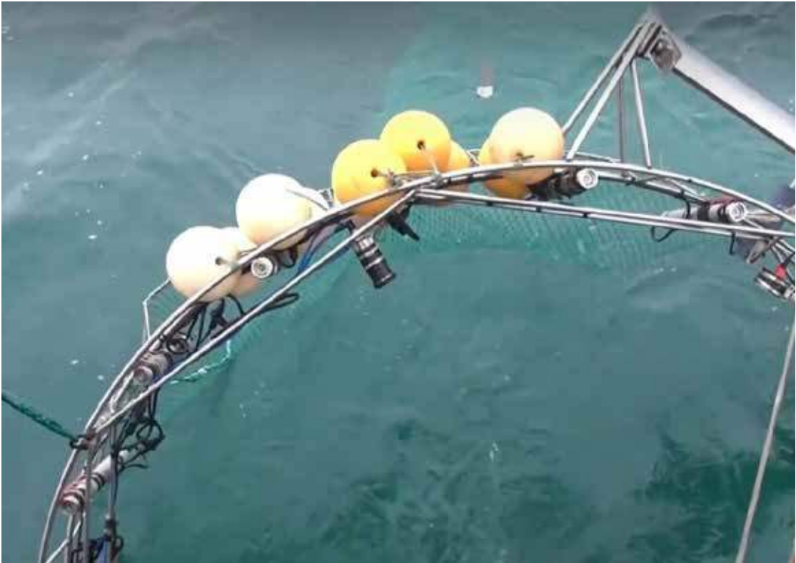
Ljóstroll sem snertir ekki hafsbotn og smalar rækju inn.
