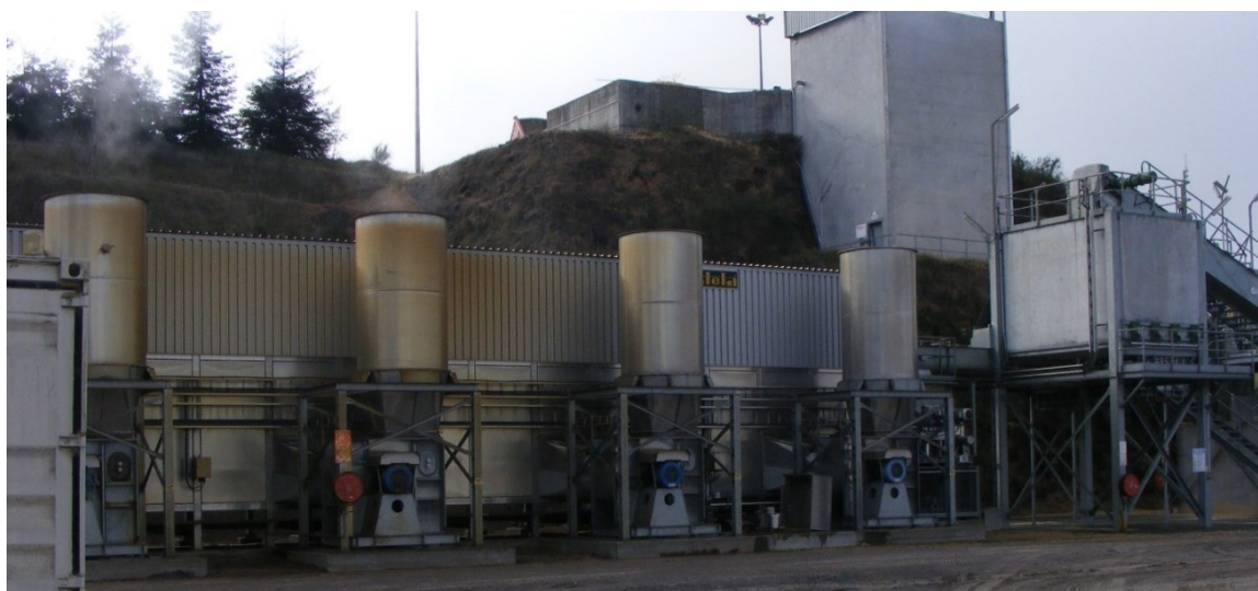
図6: 地熱エネルギーに変換するNature's Flame社の薪割り・おがくずベルト乾燥機。写真クレジット: Brian Carey, GNS Science.
