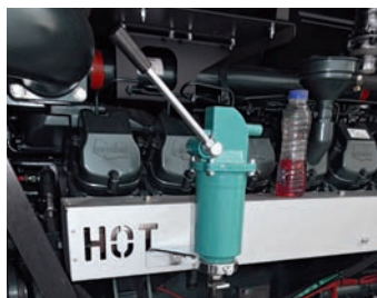
Pompa estrazione olio Oil drain pump Pompe manuelle de vidange huile
