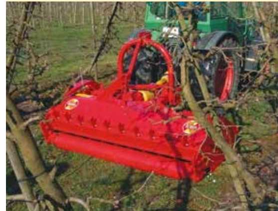
KMN met opname- en scheurvoorziening voor houtverkleining.
