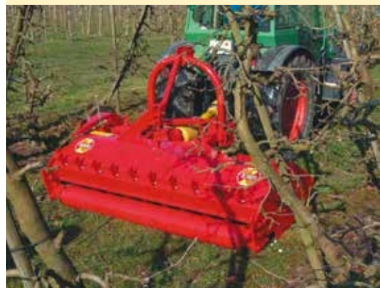
KM met opname- en scheurvoorziening voor houtverkleining
