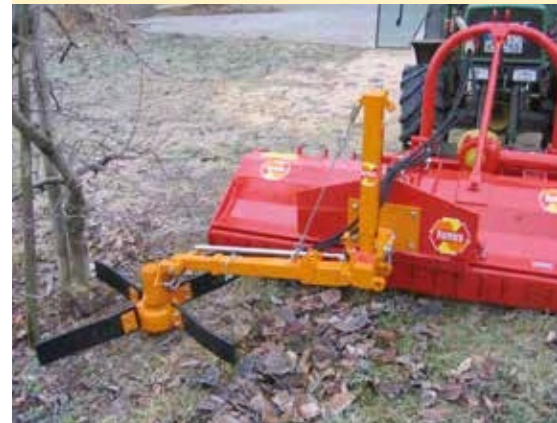
De houtruimer / rubberlappenrotor voor het opruimen van snoeihout kan aan verschillende humus-machinetypen voor front- en achteraanbouw worden gemonteerd. De houtruimer/rubberlappenrotor is geschikt voor aanbouw aan de KMN.
