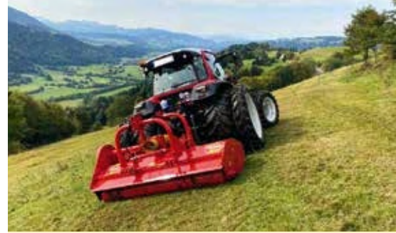
De KMF in achteraanbouw bij het vlakteonderhoud.
