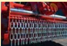
Kettinggordijn in plaats van metalen valkleppen
