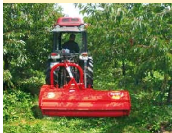
KM met opname- en scheurvoorziening voor houtverkleining
