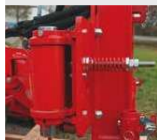
De stabiele aanrijbeveiliging zorgt voor maximale bescherming bij botsingen met obstakels.
