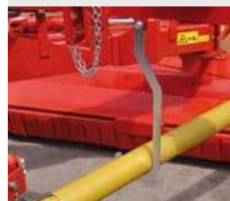
Geïntegreerde houder voor het gemakkelijk opbergen van de cardanas.
