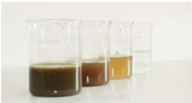
Les matières solides du lisier sont séparées de l'eau en quatre étapes. Il reste de l'eau, un concentré d'éléments nutritifs et de l'engrais solide.
