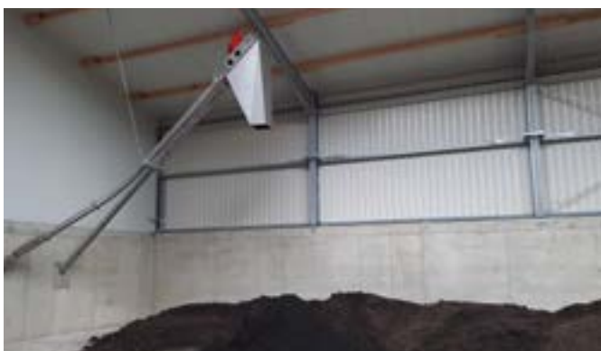
De La matière solide déshydratée a une teneur en matière sèche d'environ 30 pour cent et constitue un engrais transportable et riche en éléments nutritifs.
