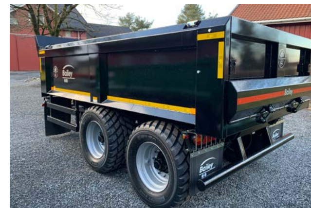
14T dumper med underkjøringsvern og Nokian CK 560/45R x 22,5 hjul.
