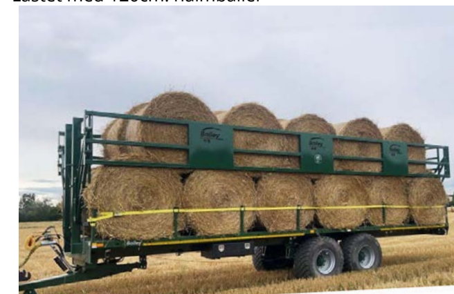
Bailey 18T med 238cm. grinder + 40 cm rekkverk med stropper. med 560/60x22,5. Lastet med 160cm. halmballer
