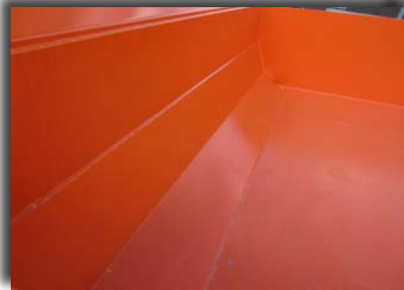
Avrundet fremvegg i 8mm. Hardox.
