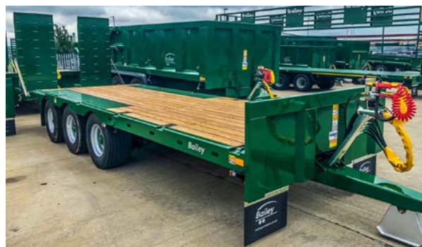
Singeldekk, dørkeplate over hjul og skvettlapper foran.
