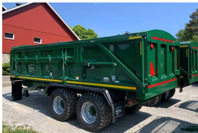
Root 14 med hydraulisk side og 560/45 22,5.
