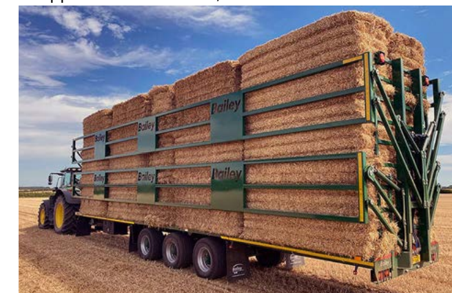
3 akslet 18T Bale 10,2m. 306 cm. grinder med 435/50x19,5. Lastet med firkantballe
