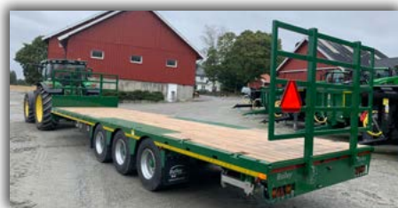
24T flatdeck med singeldekk 435/50 x 19,5 og skjermsett. Hardtre i bunn.
