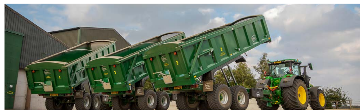
TB16 med hydraulisk baklem og 445x65R 22,5
