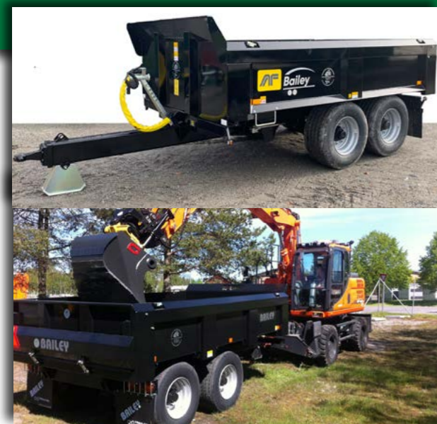
Avrundet fremvegg i 8mm. Hardox.
