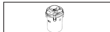
Figura 4: Conjunto de contenedor de órganos: contenedor de órganos (1) y tapa del contenedor de órganos (2)
