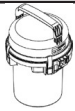
Figura 7: Conjunto do invólucro: Base do invólucro (n.º 3) e Topo do invólucro (n.º 4)
