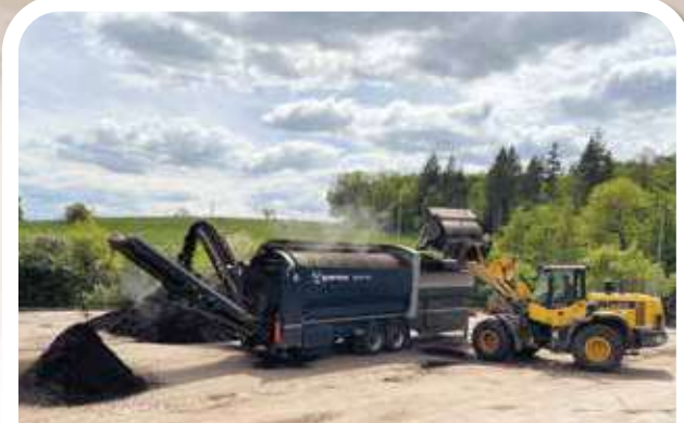
Die Endverarbeitung erfolgt mit der Trommelsiebmaschine, welche das Feinmaterial von größeren Stückchen trennt.
