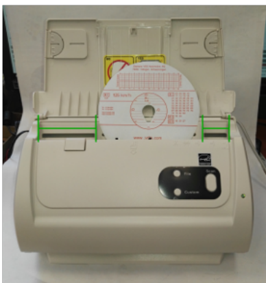
Obr. Uložení kotoučů ve skeneru.
