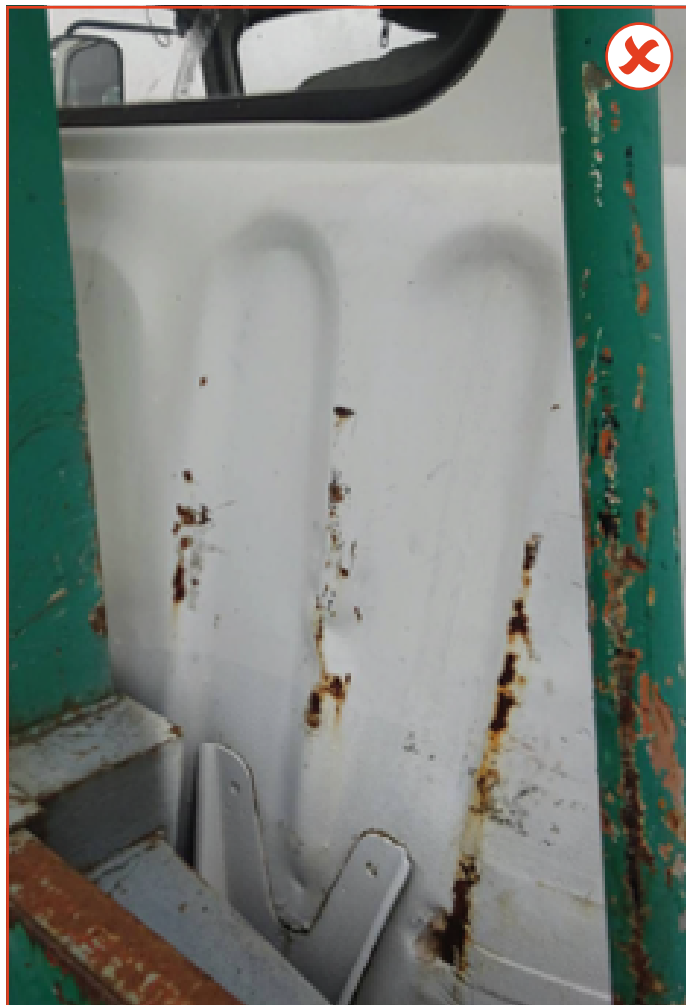
Korózia interiéru vozidla
