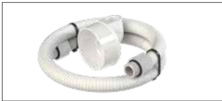
PZA-FLEX-S Als er een beperkte inbouw lengte nodig is, vervang dan het lijmslaartstuk door de PZA-FLEX-S elleboog met flexibele slang. Ingebouwde lengte verminderen met 22mm.
