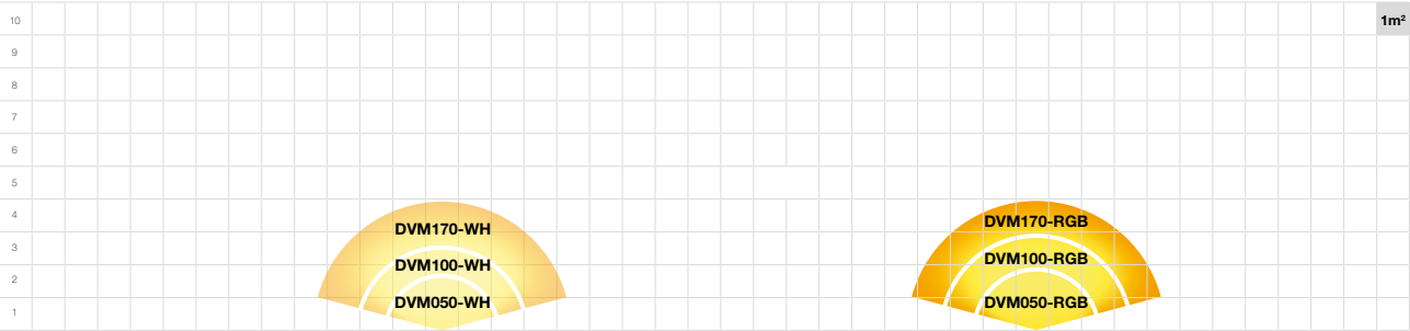
De waarden in de grafiek hebben betrekking op zwembaden met witte of lichtgekleurde wanden die 100-150 lm/m² nodig hebben. Verhoog het licht (lumen) met 50% voor middelgrote kleuren. Donkere muren zijn moeilijk te verlichten en hebben tot 250% extra licht nodig.
