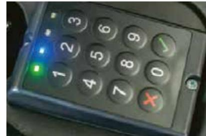
Accès au panneau par code PIN en option, permettant la saisie manuelle d'un mot de passe ou le balayage pour démarrer à l'aide de cartes RFID.
