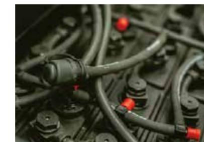
Le transpalette de 2 tonnes peut être équipé en option d'une batterie selon la norme 3VBS, ce qui réduit la longueur hors tout et rend le chariot plus compact (la batterie standard est 2PzS). Une batterie Li-ion est également disponible en option.
