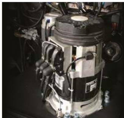
Le système d'entraînement à courant alternatif fonctionne parfaitement grâce à son moteur CA allemand Schabmüller de grande puissance et sans entretien et à sa boîte de vitesse Kordel, assurant une accélération et une décélération sans à-coups.
