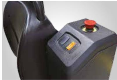
Le bouton de marche en roue libre situé des deux côtés du gerbeur permet à l'opérateur de le faire avancer ou reculer tout en marchant à côté. Il n'est donc plus nécessaire d'entrer et de sortir fréquemment, ce qui améliore considérablement l'efficacité de la préparation des commandes et la sécurité des opérations.
