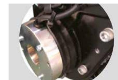
Le moteur sans balais de 48 V du 15ES-XB/XN offre une faible consommation d'énergie et des coûts de maintenance réduits en raison de l'absence de balais de carbone et d'étincelles, assurant un fonctionnement fluide et efficace.
