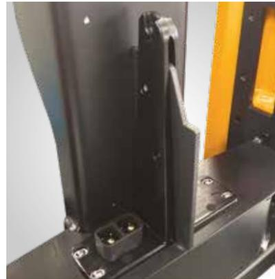
La batterie peut être positionnée rapidement et facilement à l'intérieur du compartiment, grâce au système de guidage de la batterie spécialement conçu à cet effet.
