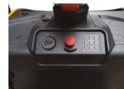
L'instrument de contrôle multifonctionnel affiche l'état du préparateur de commandes, la capacité de batterie, le temps de travail, la vitesse de translation et l'angle de braquage.
