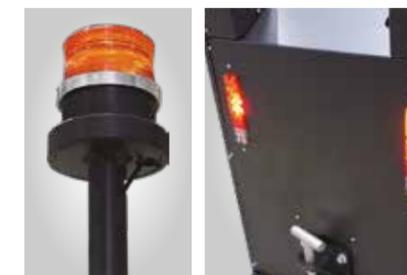
Le feu de virage, le feu de freinage et le feu de stationnement renforcent la sécurité de la conduite, tandis que le feu d'avertissement accroît encore la visibilité et la sécurité du chariot lorsqu'il est utilisé.
