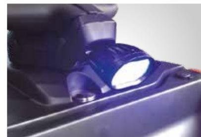
Le feu bleu avant standard s'active automatiquement lorsque le préparateur de commandes avance et tourne simultanément à l'aide de la poignée, ce qui renforce la sécurité des opérations.
