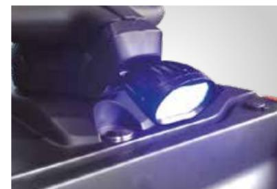
Le feu bleu avant standard s'active automatiquement lorsque le tracteur avance et tourne simultanément à l'aide de la poignée, ce qui renforce la sécurité des opérations.
