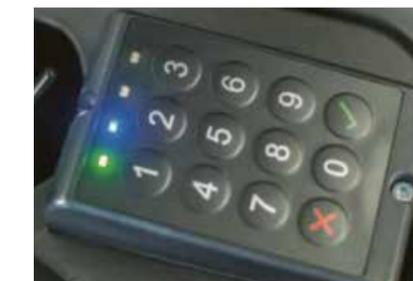
Le panneau à code PIN, compatible avec les codes PIN et les cartes RFID, simplifie le contrôle d'accès pour les flottes à opérateurs multiples.
