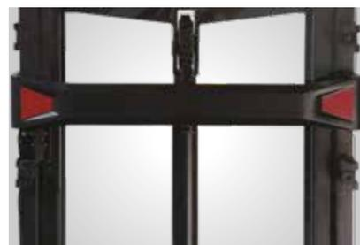
Les profils de mât larges, ainsi que la chaîne de levage positionnée au-dessus du vérin de levage, assurent une visibilité optimale des fourches et un champ de vision clair et dégagé.
