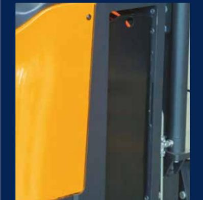
L'option de remplacement latérale de la batterie permet à nos clients d'utiliser le chariot dans le cadre d'opérations en équipes multiples sans perdre de temps avec le remplacement compliqué de la batterie supérieure. À l'aide d'un chariot spécialement conçu, les batteries peuvent être remplacées rapidement et sans effort.
