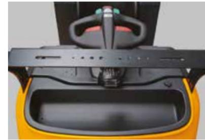
Le support de montage standard permet l'installation d'équipements, tels qu'un lecteur de codes-barres, un tableau de classement et une unité WMS, entre autres.
