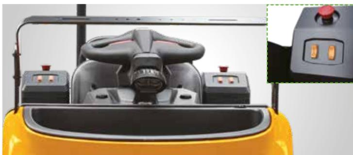
Le bouton de marche en roue libre situé de part et d'autre du préparateur de commandes permet à l'opérateur d'avancer ou de reculer le préparateur de commandes et de lever les fourches tout en marchant à côté. Il n'est donc plus nécessaire d'entrer et de sortir fréquemment, ce qui améliore considérablement l'efficacité de la préparation des commandes et la sécurité des opérations.
