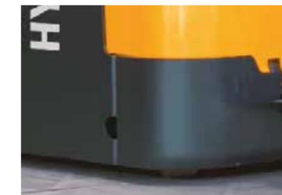
Un tablier de 8 mm d'épaisseur offre une protection contre les collisions, tandis que le couvercle en acier protège la batterie.
