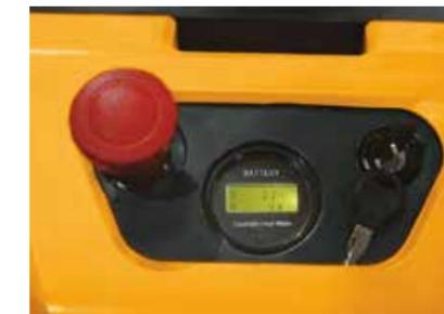
Dispositif de protection contre la décharge profonde de la batterie, coupe automatique en cas de faible tension et fonction de levage pour une durée de vie prolongée de la batterie.\*\*
