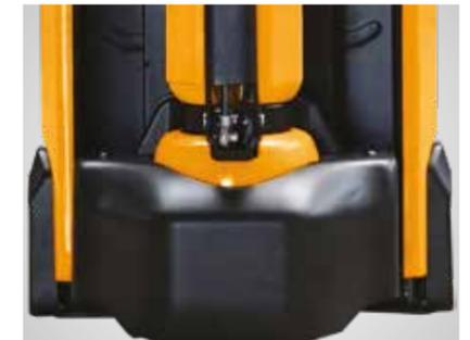
Le tablier en acier robuste protège les pieds de l'opérateur pendant l'utilisation et les composants du chariot contre les collisions avec des objets.
