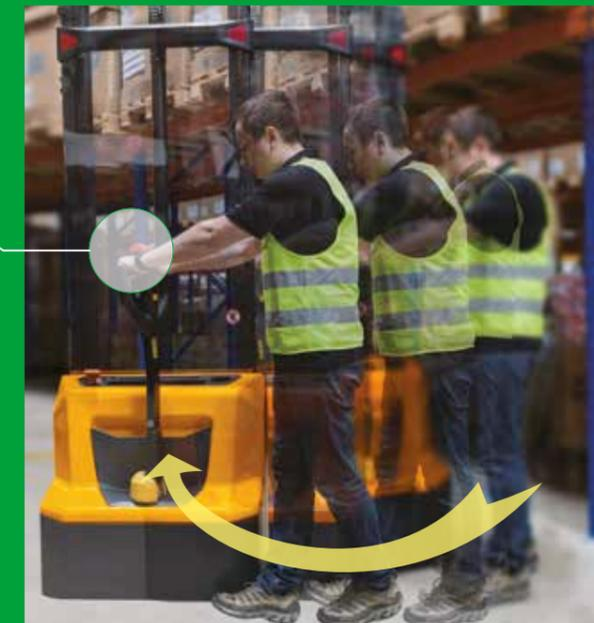
Le timon est soutenu par un ressort pneumatique qui permet de ramener le timon en position verticale sans heurter l'extrémité.
