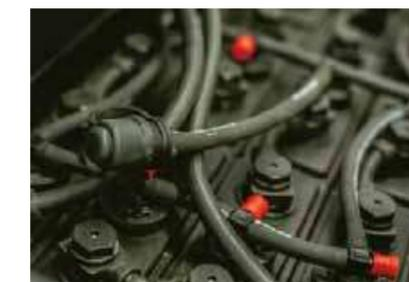
Der 2-Tonnen-Stapler kann optional mit einer Batterie nach dem 3VBS-Standard ausgestattet werden, wodurch sich die Gesamtlänge verringert und der Stapler kompakter wird (die Standardbatterie ist 2PzS). Ein Li-Ion-Akku ist ebenfalls als Option erhältlich.
