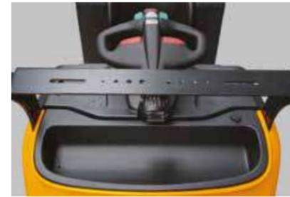
Die Standardhalterung ermöglicht die Installation lokaler Geräte, wie z. B. Barcode-Scanner, Klemmbrett und WMS-Einheit, um nur einige zu nennen.
