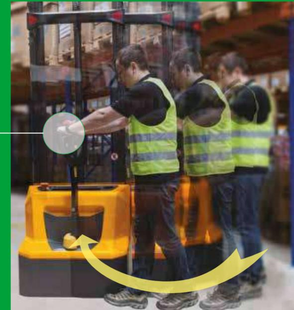
Die Deichsel wird durch eine Luftfeder gestützt, die dazu beiträgt, dass die Deichsel in ihre senkrechte Position zurückkehrt, ohne gegen den Endpunkt zu schlagen.
