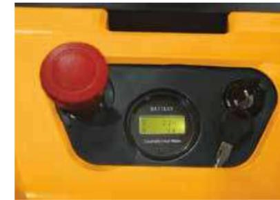
Tiefentladeschutz für die Batterie, automatische Abschaltung bei niedriger Spannung und Hebefunktion für eine längere Lebensdauer der Batterie.
