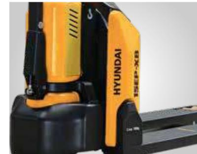
Der Staplerahmen ist von gestanzten Stahlelementen umgeben, die bei den Modellen 12EP-XB und 15EP-XB den Schutz der Komponenten gewährleisten.
