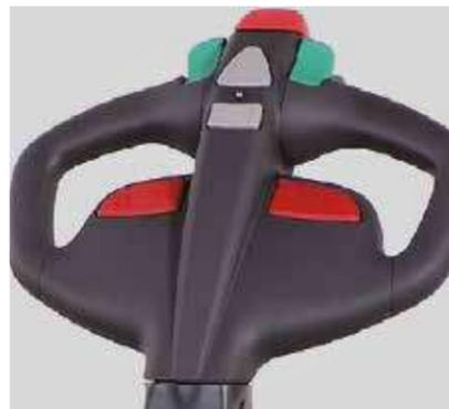
Die Rema-Deichsel bietet eine außergewöhnliche Ergonomie und ein äußerst zuverlässiges Steuerungssystem. Die berührungslösen Wippschalter für die Hebe- und Senkfunktion sorgen für eine lange Langlebigkeit und machen ihn zu einer zuverlässigen Wahl für den Dauereinsatz.
