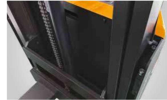
Es werden echte Mastprofile verwendet, die im Gegensatz zu gebogenen Standardlösungen eine höhere Stabilität und eine lange Lebensdauer aufweisen.
