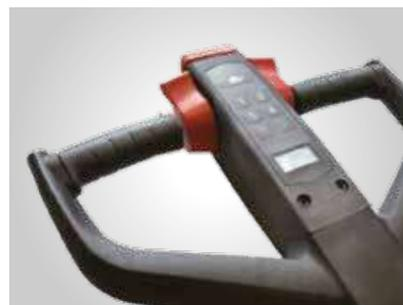
Die Deichsel des 12ES-XB/XN ist aus hochfestem Fiberglas gefertigt, die des 15ES-XB/XN aus Stahl.
