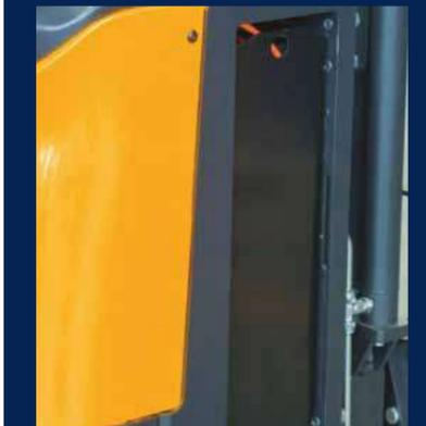
Die Option des seitlichen Batteriewechsels ermöglicht es den Kunden, den Stapler im Mehrschichtbetrieb einzusetzen, ohne Zeit für den komplizierten Austausch der oberen Batterie zu verschwenden. Mit Hilfe eines speziell entwickelten Wagens können die Batterien schnell und mühelos ausgetauscht werden.
