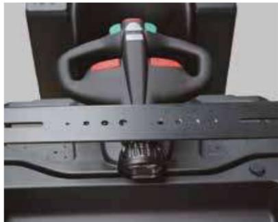
Das seitliche Batteriewechselfach, kombiniert mit einer verstellbaren Halterung, macht den Batteriewechsel einfacher und schneller.
