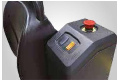
Die Nachlauftaste an beiden Seiten des Staplers ermöglicht es dem Bediener, den Stapler vorwärts oder rückwärts zu bewegen, während er nebenher läuft. Dadurch entfällt die Notwendigkeit eines häufigen Ein- und Ausstiegs, was die Effizienz der Kommissionierung und die Betriebssicherheit erheblich verbessert.
