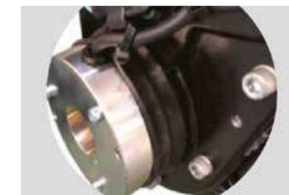
Der bürstenlose 48-V-Motor des 15ES-XB/XN bietet einen geringen Energieverbrauch und niedrige Wartungskosten, da er ohne Kohlebürsten und Funken auskommt und so einen störungsfreien, reibungslosen Betrieb gewährleistet.
