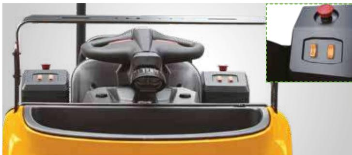
Die Nachlauftaste an beiden Seiten des Kommissionierers ermöglicht es dem Bediener, den Kommissionierer vorwärts oder rückwärts zu bewegen und die Gabeln anzuheben, während er nebenher läuft. Dadurch entfällt die Notwendigkeit eines häufigen Ein- und Ausstiegs, was die Effizienz der Kommissionierung und die Betriebssicherheit erheblich verbessert.
