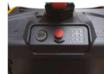
Das multifunktionale Kontrollinstrument zeigt Kommissionierzustand, Batteriekapazität, Arbeitszeit, Fahrgeschwindigkeit und Lenkeinschlag an.
