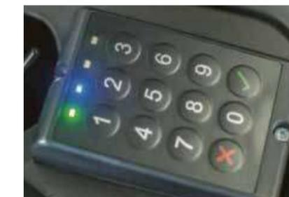
Das PIN-Code-Panel, das sowohl mit PIN-Codes als auch mit RFID-Karten kompatibel ist, vereinfacht die Zugangskontrolle bei Fuhrparks mit mehreren Bedienern.
