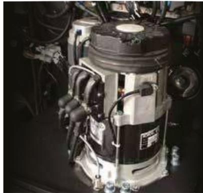
Das AC-Antriebssystem funktioniert dank des leistungsstarken, wartungsfreien deutschen AC-Motors von Schabmüller und des Kordel-Getriebes perfekt und gewährleistet eine gleichmäßige Beschleunigung und Verzögerung.
