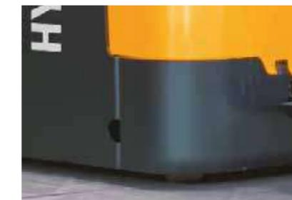
Eine 8 mm dicke Schürze schützt vor Kollisionen, während die Batterieabdeckung aus Stahl die Batterie schützt.
