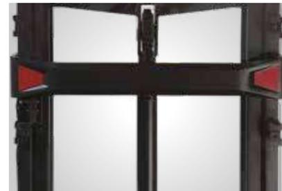
Breite Mastprofile und die über dem Hubzylinder positionierte Hubkette sorgen für optimale Sicht auf die Gabeln und ein freies, ungehindertes Sichtfeld.
