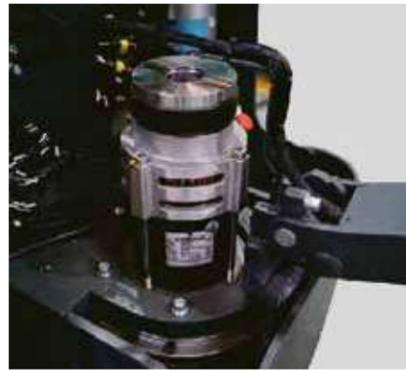
Die leistungsstarke AC-Antriebseinheit besteht aus Komponenten von weltweit führenden Industrieunternehmen. Mit dem von Schabmüller entwickelten und produzierten AC-Motor in Verbindung mit dem hochwertigen ZF-Getriebe und der elektromagnetischen Intorq-Bremse erreicht der Stapler eine Höchstgeschwindigkeit von 8 km/h.
