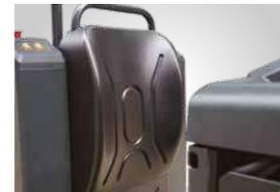
Sicherheitsflanken und rutschfeste Oberflächenmaterialien auf beiden Seiten der Rückenlehne sichern den Fahrer bei schnellen Kurvenfahrten und erhöhen die Fahrsicherheit erheblich.
