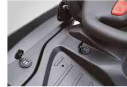
Der doppelte USB-Ladeanschluss versorgt weitere Geräte mit Strom.
