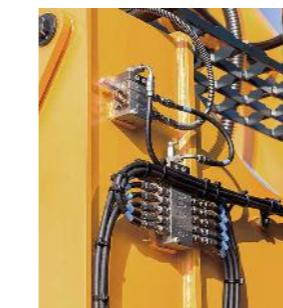
Die optionale **automatische Schmierung** schmiert die Schmierpunkte nach Bedarf. Immer mit der richtigen Dosierung und mit gleichmäßigen Auftrag für minimalen Schmiermittelverbrauch und weniger Verschwendungen.
