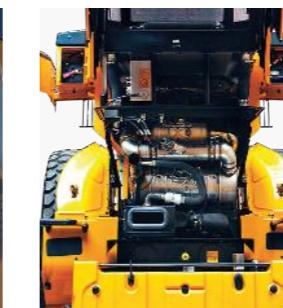
Die **aufklappbare Motorhaube** ist komplett einziehbar und elektrisch zu öffnen, für leichten Zugang zum abgedichteten Motorraum und Kühler. Die Brandgefahr im Motorraum durch zufließende Fremdmaterialien wurde eingedämmt.
