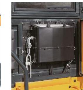
Der **Klimaanlagenfilter** aus einem speziellen Hochleistungsmaterial ist leicht auswechselbar.
