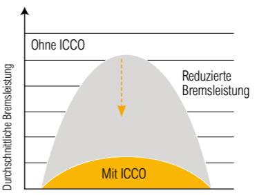
Die **intelligente Kupplungstrennfunktion (ICCO)** minimiert den Leistungsverlust im Drehmomentwandler und verhindert übermäßige Leistungsverluste beim Bremsen. Das reduziert die Wärmeentwicklung und den Verschleiß der Bremsscheibe.
