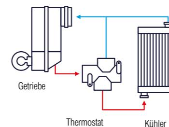
Der HL960A verfügt über ein **Thermostat für die Getriebekühlung**. Dieses erwärmt das Öl schnell auf und hält es im Winter immer auf der optimalen Betriebstemperatur, was die Komponenten schützt und die Effizienz erhöht.
