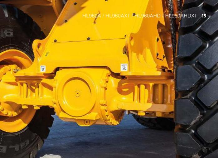
Die **Achsen** des HL960AHD sind für absolute Zuverlässigkeit und Schwerlast-Dauerbetrieb ausgelegt. Die Achse bietet hervorragende Stabilität und Kraftübertragung, ist aber gleichzeitig kompakt und leicht ausgeführt. Der Einsatz nasser Lamellenbremsen verringert die Bremsverluste und verbessert dadurch die Effizienz.
