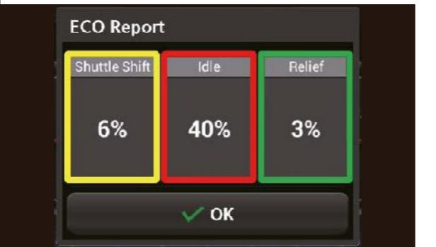
Mithilfe des **Eco-Berichts** kann sich der Bediener Echtzeitdaten zur Maschinenleistung anzeigen lassen und so leicht eine effiziente Arbeitsweise anwöhnen.
