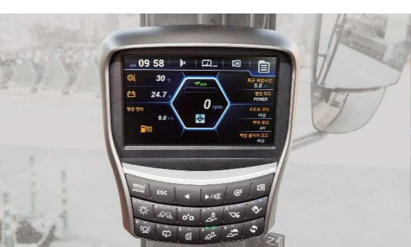
Die **Instrumententafel** ist für schnellen, einfachen Zugriff auf Maschinenstatusinformationen während der Arbeit optimiert. Sie enthält einen leicht ablesbaren 7"-Touchscreen.
