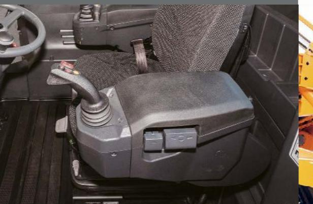
Der HL960A ist serienmäßig mit einem **großen, komfortablen Sitz** mit Heizung ausgestattet. Sitz und Armlehne können mehrfach verstellt werden. Für noch mehr Komfort ist optional auch eine Version mit Luftfederung erhältlich. Der **elektrohydraulische Bedienhebel** erfordert weniger Kraft zur Bedienung der Anbaugeräte, so dass Sie länger und produktiver arbeiten können.
