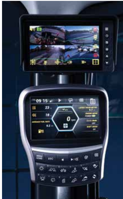
Maschinenstatus-Gruppe Alle Anzeigen zum Maschinenstatus sind für eine einfache, effiziente Überwachung zentral in einer Gruppe angeordnet.
