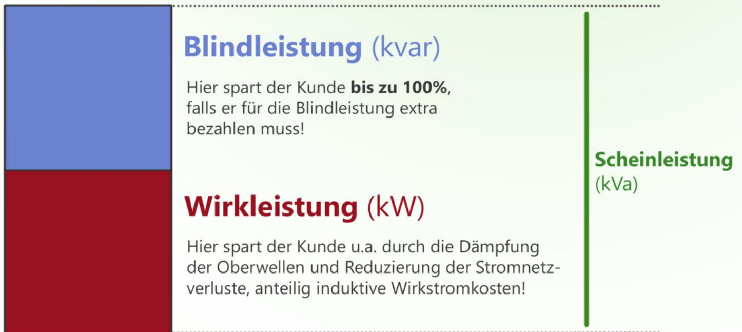
Die aus dem elektrischen Netz entnommene Leistung  $P$  ist gleich dem Produkt aus der Spannung  $U$ , dem Strom  $I$  und dem Phasenverschiebungswinkel  $\varphi$  (Phi).
