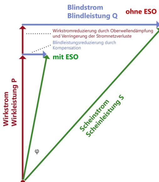
Um die Funktionsweise der ESO-Anlage vollständig zu verstehen, ist es essentiell, die Grundlagen der elektrischen Leistung in Wechselstromnetzen zu kennen. In jedem Wechselstromnetz existieren drei Arten von Leistung, die zusammen das sogenannte Leistungsdreieck bilden:
