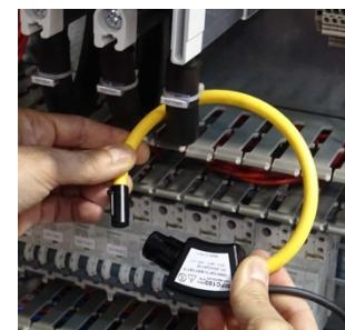
**Die Orientierung der Spule ist wichtig:** Der Pfeil (siehe 6.3.3.1 falls fehlend) auf dem Verschluss der Spule muss in Richtung des Energieflusses zeigen, also vom Einspeisepunkt zum Verbraucher. Eine falsche Orientierung führt zu einer Vorzeichenumkehr (negativer PF-Wert) bei der Messung und damit zu Fehlfunktionen.
