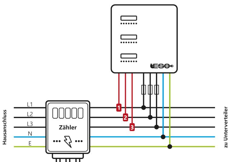
Installieren Sie den Sicherungshalter mit den 25A-Sicherungen an einer gut zugänglichen Stelle. Die Sicherungen müssen vor der ESO-Anlage installiert werden und jederzeit zugänglich sein. Beschriften Sie den Sicherungshalter eindeutig mit "ESO-Kompensation" oder ähnlich.
