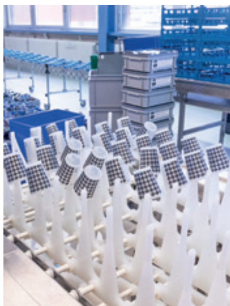
Les deux chaînes de lavage et séchage peuvent traiter jusqu'à 5000 gobelets par heure.
