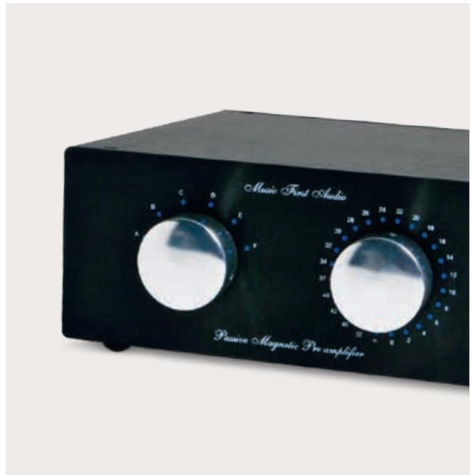
Einsatz eines A47 Schalters mit ferngesteuertem Motorantrieb für den Einsatz im Audiobereich: Produkte von Music First Audio (MFA) in Grossbritannien verwenden nur die höchste Qualität an Komponenten. Das magnetische, berührungslose Kontaktsystem des Codierschalters X4 garantiert eine maximale Robustheit und Zuverlässigkeit bei extrem hoher Lebenserwartung.
