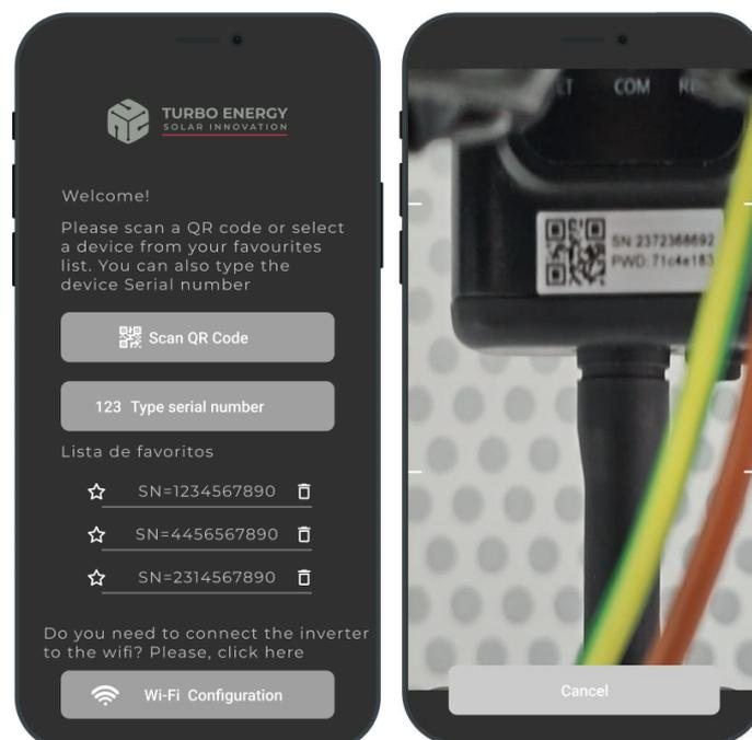
Una vez que hayas escaneado el código QR, aparecerá la siguiente pantalla. Asegúrate de estar conectado a una red de 2.4 GHz e ingresa la contraseña de esa red Wi-Fi.
