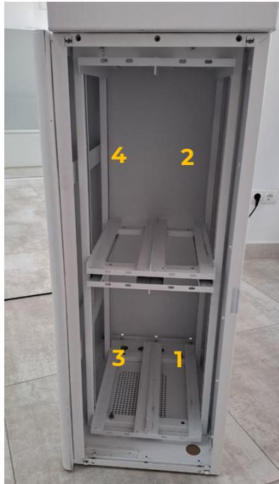
Si solo se utiliza una batería, debe colocarse en la posición uno. Para ello, se debe utilizar el par de cables de alimentación largo. La conexión del cableado será la siguiente:
