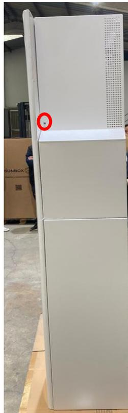
Una vez quitado el tornillo, la puerta central permanece sujeta a la parte superior del gabinete mediante piezas de encaje a presión y dos tornillos superiores. Para retirarla, primero quite los tornillos y luego tire suavemente de la puerta frontal hasta que las piezas de encaje se liberen.
