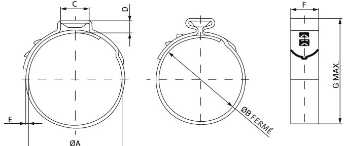
Le collier à oreille ajustable a été conçu pour une utilisation de pose rapide et pour des faibles et moyennes pressions.
