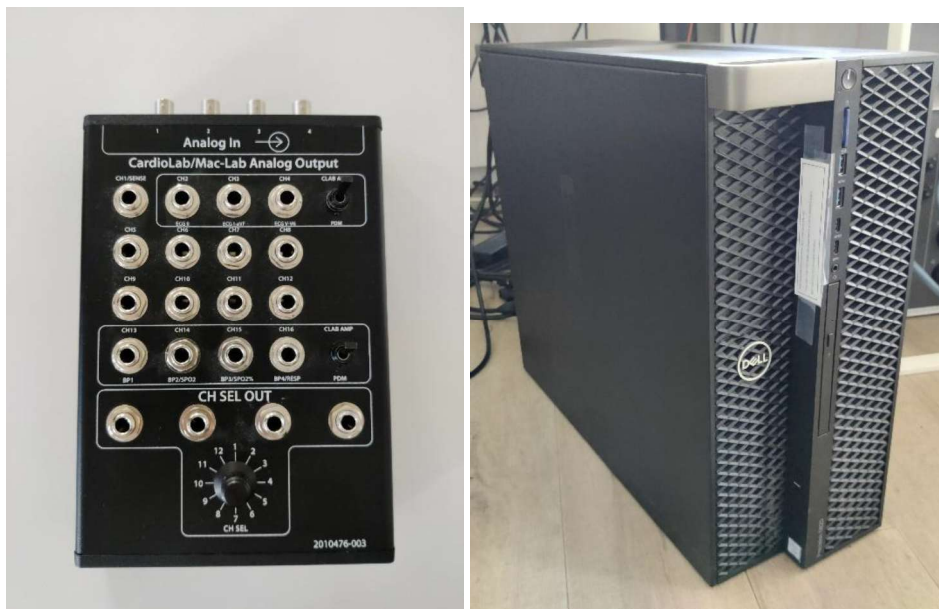
Boîtier de sortie analogique (à gauche) et poste de travail CardioLab™ de GE (à droite)
