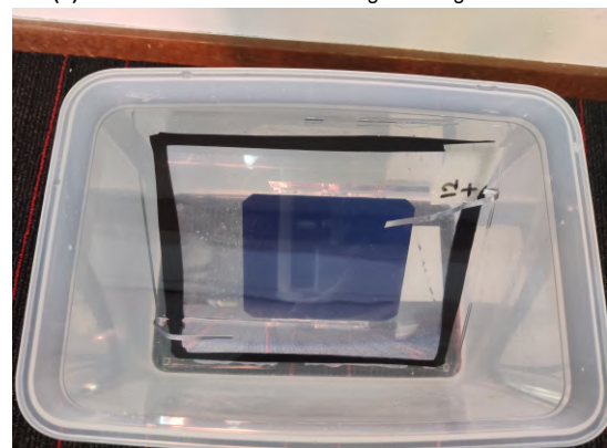
(d) air-filled Module 12 submerged in water
