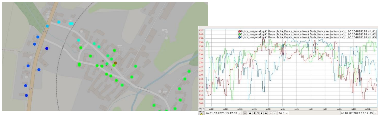
Obrázek 6: Obec Krsice - lokalita s podpětím a průběh napětí na konci větve
