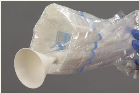
Figure 23 S'assurer que les spatules sont insérées jusqu'au fond des fourreaux
