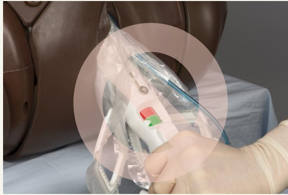
Figure 52 Zone rouge visible dans la fenêtre de contrôle
