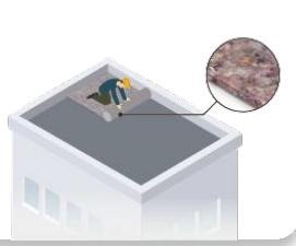
Rolle das Schutzvlies mit einer kleinen Überlappung ca. 10 cm aus. An bestehenden Dachaufbauten und Entwässerungen schneide vorsichtig eine entsprechende Aussparung aus. Schütze die Entwässerung mit der entsprechenden Abdeckung.
