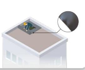
Bei Bestandsgebäuden rolle die Wurzelschutzfolie mit einer **50 cm Überlappung** aus. Achte darauf, dass auch der erhöhte Dachrand abgedeckt wird. Bei Dachaufbauten schneide ein "x" und bei Entwässerungen ein "o" vorsichtig mit einer Schere.
