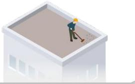
Entferne vorhanden Kies. Grober Schmutz, Abfälle und Materialien sollten zunächst händisch entfernt werden. Fege anschließend das Dach sauber. Prüfe, dass das Dach nicht beschädigt ist.
