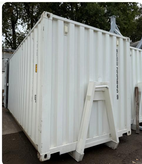
La berce ampliroll s'utilise avec un camion équipé d'un bras hydraulique à crochet. Le conteneur ou caisson est accroché au crochet avant, puis tiré ou déchargé grâce aux rouleaux arrière qui facilitent le mouvement.
