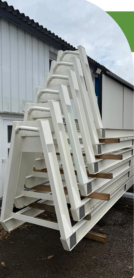
La berce ampliroll est un châssis spécialement conçu pour accueillir et transporter des conteneurs ou caissons via un système de bras hydraulique à crochet. Robuste et fonctionnelle, elle est réalisée en profilés acier (IPN, UPN) avec renforts, rouleaux arrières équipés de graisseurs et bagues en bronze, ainsi qu'un crochet de préhension normalisé.
