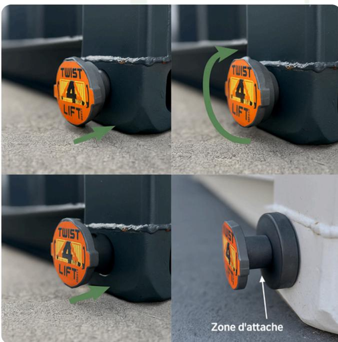
Le fonctionnement est intuitif : insérez le crochet dans le coin ISO du conteneur, effectuez une rotation de 180°, puis tirez la partie arrondie vers vous pour verrouiller le dispositif. Il ne reste plus qu'à y fixer une sangle ou une élingue.
