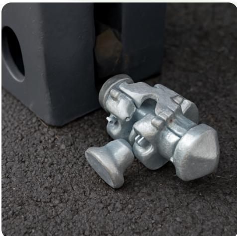
Le twist-lock horizontal est un élément de fixation essentiel dans le transport maritime et logistique.
