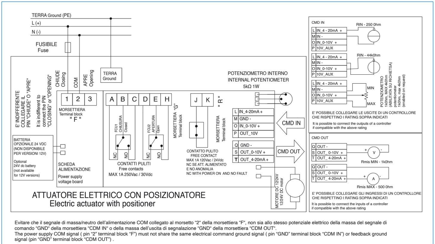
Evitare che il segnale di massa/neutro dell'alimentazione COM collegato al morsetto "2" della morsetteria "F", non sia allo stesso potenziale elettrico della massa del segnale di comando "GND" della morsetteria "CDM IN" o della massa dell'uscita di segnalazione "GND" della morsetteria "CDM OUT".
