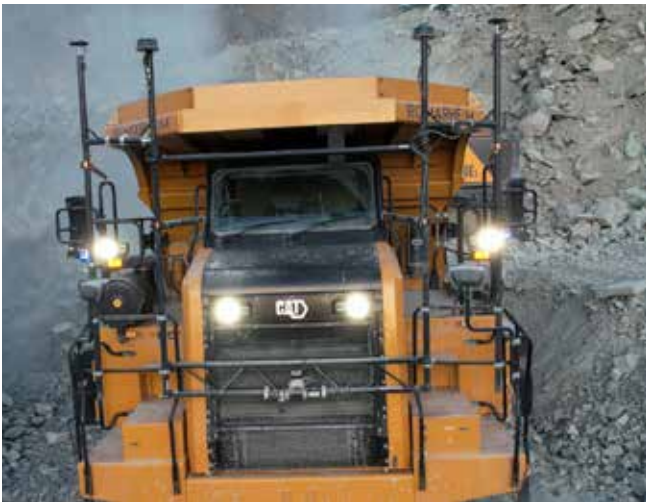
»2: AI-controlled driverless dump truck between the quarry face and the primary crusher »2: KI-gesteuerter fahrerloser Dump-Truck zwischen Abbauwand und Vorbrecher
