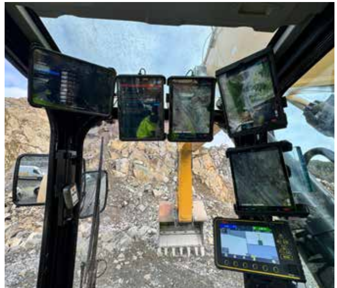
»3: Control of the dump trucks from the hydraulic excavator »3: Steuerung der Dump-Trucks vom Hydraulikbagger
