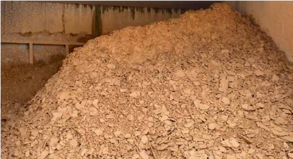
»5: Freinberg Orange Filter Kaolin as a secondary raw material »5: Filterkaolin Freinberg Orange als Sekundärrohstoff
