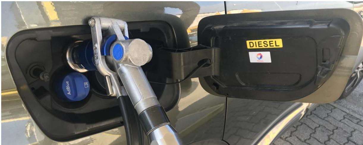
1. Repérer le côté desservi par la pompe de GPL et placer le véhicule de façon à positionner l'orifice GPL en regard de la pompe GPL
