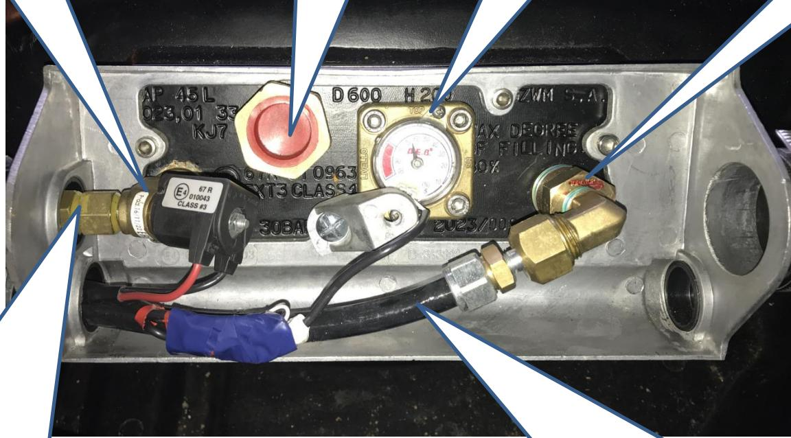
Ligne de gaz allant du réservoir GPL vers l'électrovanne avant côté moteur
