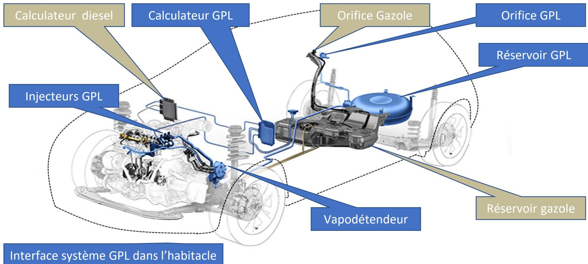
Toutes les cases en bleu représentent les éléments ajoutés au véhicule pour réaliser la conversion au GPL d'un moteur diesel par le kit Rétrogaz
