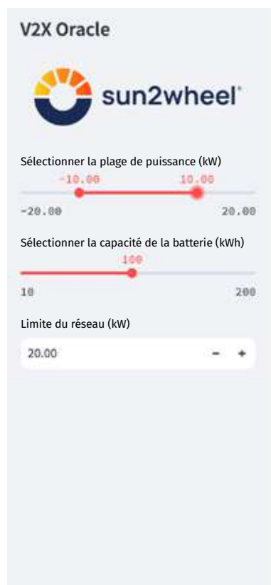
Fig. 1: Illustration du prototype d'un simulateur en ligne simple. Le client peut définir à tout moment un état de charge minimal, à l'intérieur duquel l'optimisation calcule le plan de charge offrant les économies ou les revenus les plus élevés.
